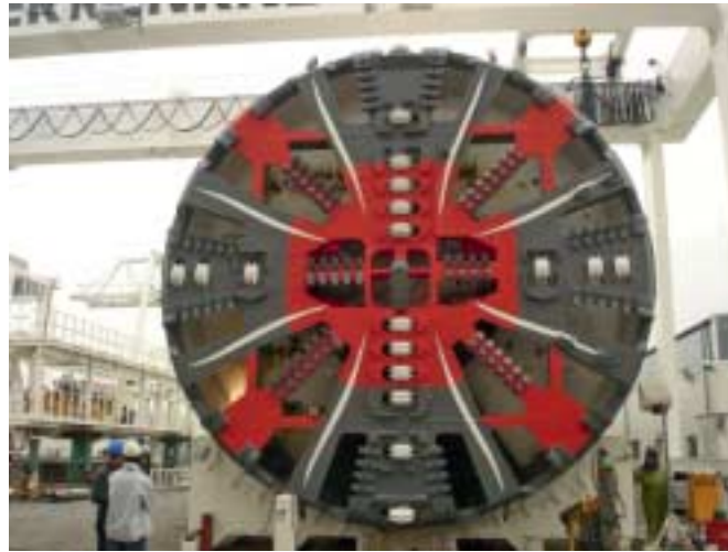
4 TBM S-352 bei der Abnahme im Werk
