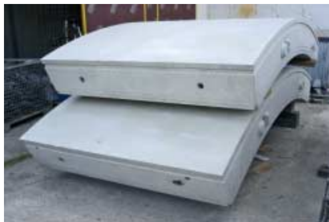
5 Tübbingproduktion bei Max Bögl in Hamminkeln
