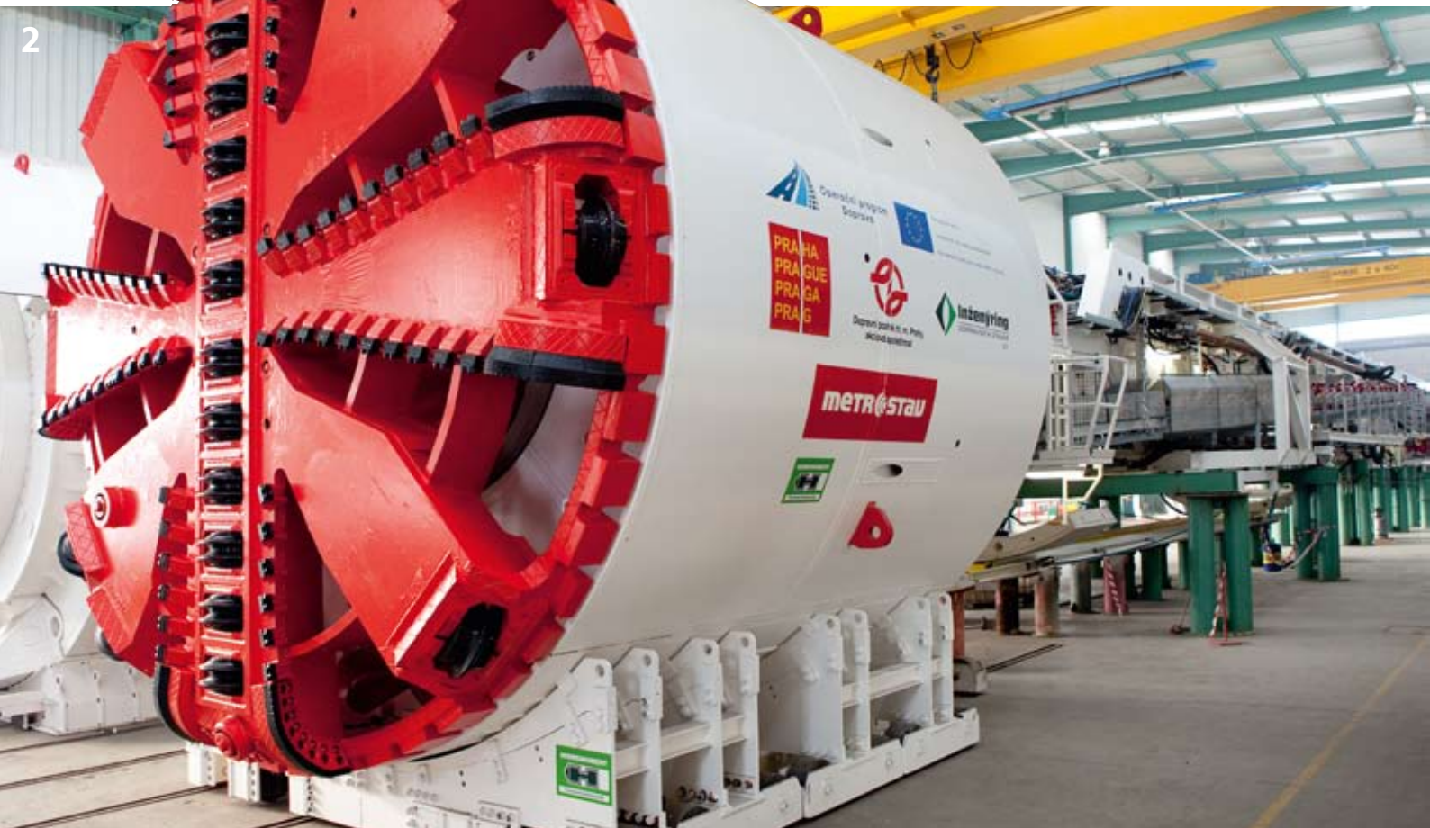
Montierter EPB-Schild (6,1 m Durchmesser) für die Erweiterung der U-Bahn-Linie A im Herrenknecht-Werk in Deutschland Assembled 6.1 m diameter EPB Shield for Prague Metro Line A extension at the Herrenknecht AG workshop in Germany
