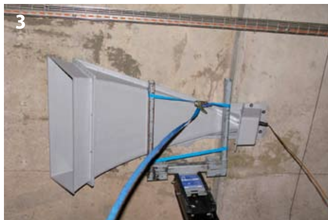
Grenzflächenhorn für Tunnelanwendungen im Versuchsaufbau Pressure zone horn for tunnel applications in the test set-up
