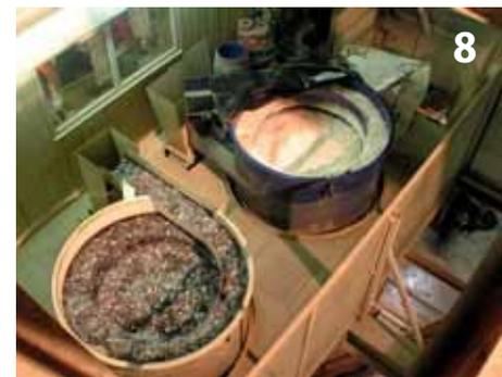
Automatische Förderung und Dosierung mit Incite DE SF 500, Dramix Stahldrahtfasern und Duomix M6
