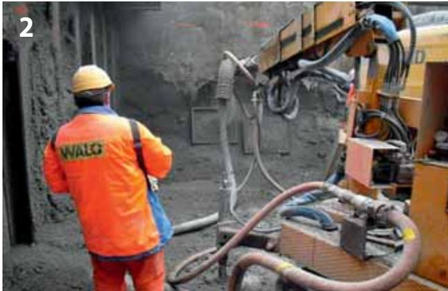
Herstellung eines Prüfkörpers aus Stahlfaserspritzbeton (im Hintergrund sind die Schalungsformen erkennbar)
