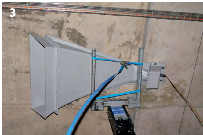
Grenzflächenhorn für Tunnelanwendungen im Versuchsaufbau
