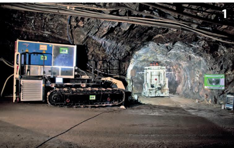
Neu entwickelte Boxhole Boring Machine (BBM)
