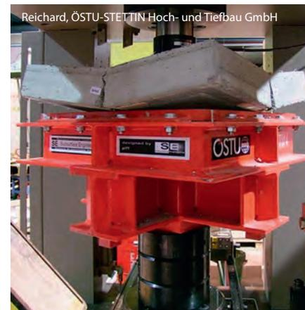
Prüfung von Spritzbeton im Labor
