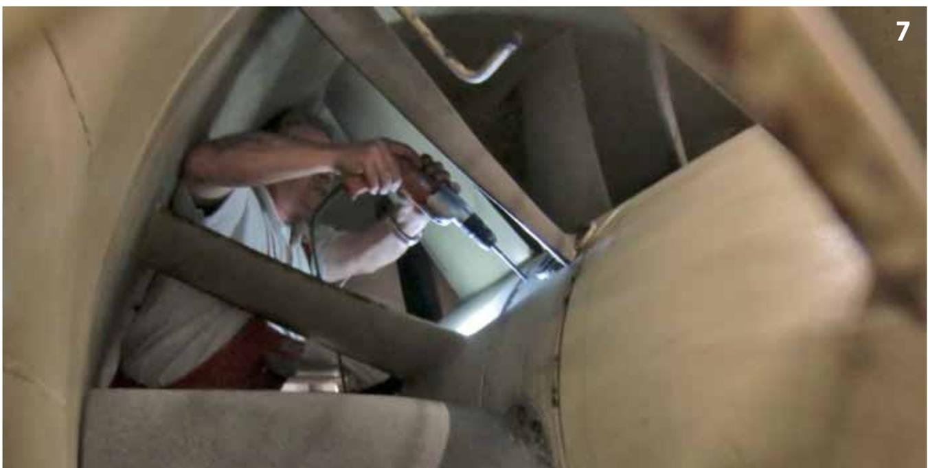
Montagearbeiten am Laufrad zur Befestigung der Ausgleichsgewichte in der Laufradnabe
