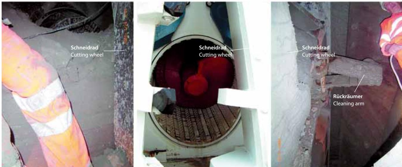
5 Links: Blick von der Ortsbrust durch die Schneidradöffnung auf eine Verbackungsmauer als „Hindernis“ vor der Förderschneckenöffnung. Mitte: Vergleichsfoto vor Vortriebsbeginn mit Blick durch die Schneidradöffnung in Richtung Förderschnecke. Rechts: Nachträglich installierter Rückräumer
