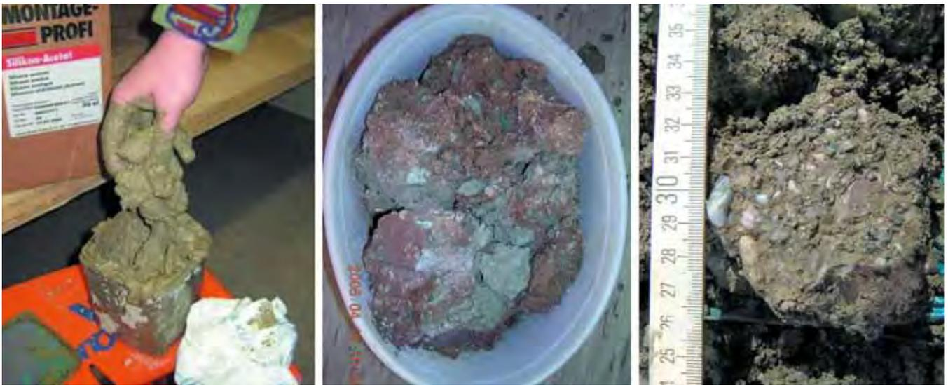
3 Links: Verklebungsmaterial mit plastischer Konsistenz. Mitte: Probe einer festen Verbackung aus einem offen gefahrenen Schildvortrieb. Rechts: Steife Verklebungsmatrix mit eingepressten Kieskomponenten aus einem Hydroschildvortrieb
