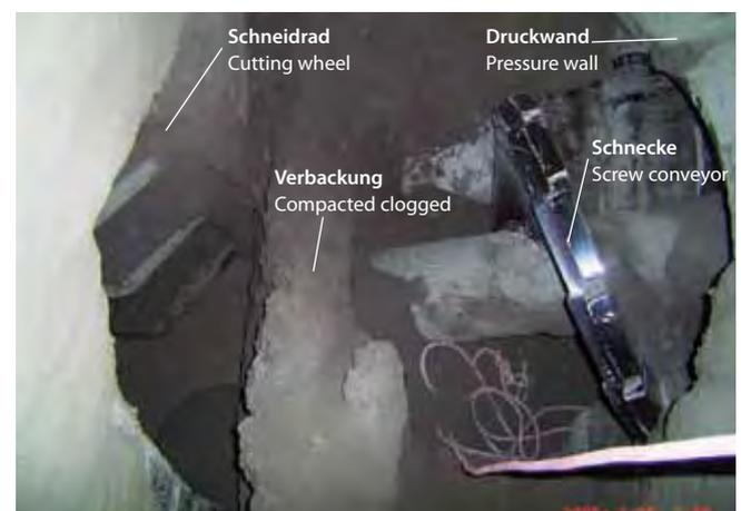
4 Mauerartige Verbackung zwischen vollständig ausgefahrner Förderschnecke und Schneidrad
