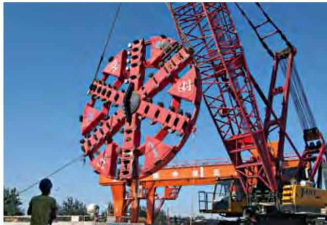
Der Speichenbohrkopf der Robbins EPB-TBM für die Metroarbeiten in Peking
