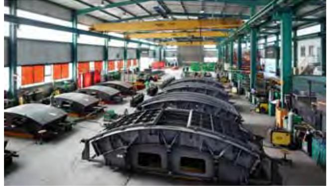
Herrenknecht Formwork lieferte für das Projekt millimetergenaue Schalungen für die Produktion von 18 t schweren Tübbingen
