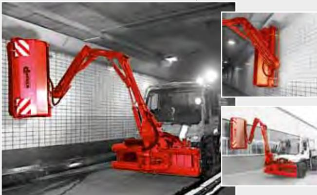
Diese Front-Ausleger werden mit entsprechenden Vorsätzen zu Reinigungs-Profis für Wände, Verkehrsschilder und Leitpfosten...
