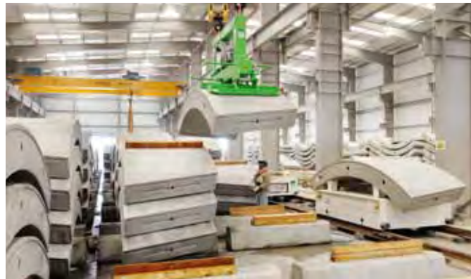
Fertigung der Tübbinge aus sulfatresistentem Stahlfaserbeton für das STEP-Abwasserprojekt in Abu Dhabi
