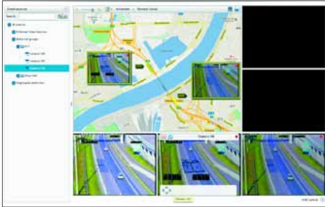
Benutzerschnittstelle des Flux Managementsystems User interface of the Flux management system
