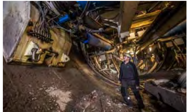
Ein Robbins Field Service Techniker inspiziert die Verspannung einer der Liaoning NOW Hartgesteins-TVM
