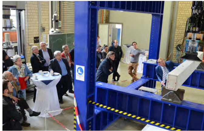
Prof. Dr. Dietmar Mähner (rechts) erläutert die Rissbildung an einem Stahlbetonbalken im neuen Universalprüfrahmen des bautechnischen Zentrallabors der FH Münster
