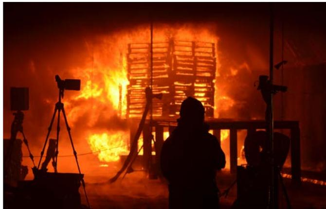
Realbrandversuch im Tunnel
