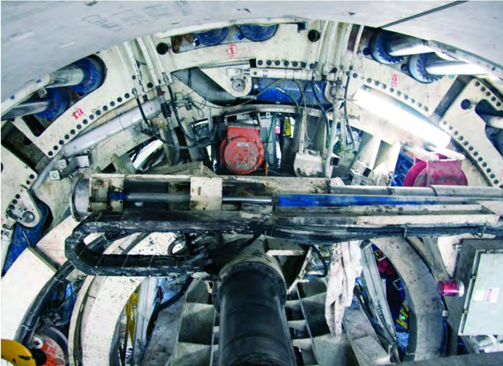
In der Crossover XRE TVM wurde für die Baugrundkonsolidierung eine Konstruktion zur Schirmbohrung eingebaut. Ein zweites Sondier- und Injektionsbohrgerät befindet sich weiter hinten an der Maschine
