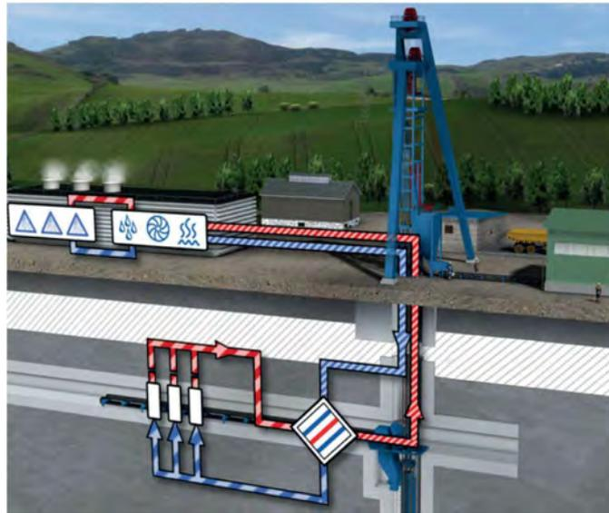
Als zentrales Element der Kühlanlage wurde für den Teilabschnitt Sedrun ein „Pressure Exchange System“ (P.E.S.) installiert, das die Schnittstelle zwischen dem Hochdruck- und dem Niederdruckwasserkreislauf der Kühlung bildet
