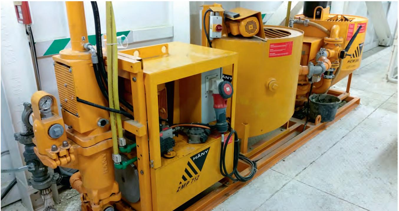
4 Pumpenstation (Injektionspumpe) auf der TVM für die Zugabe von Bentonit direkt in die Abbaukammer
