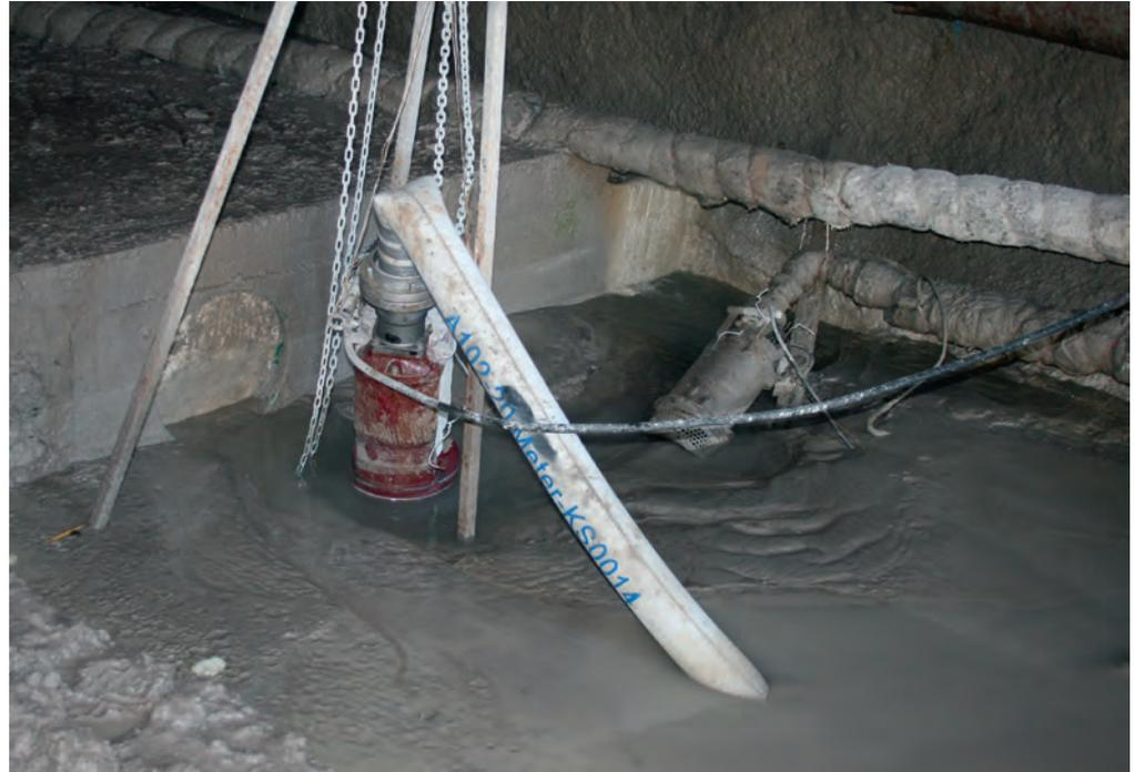
SPT Pumpen verfügen über einen eingebauten Motorschutz und sind absolut trockenlaufsicher
