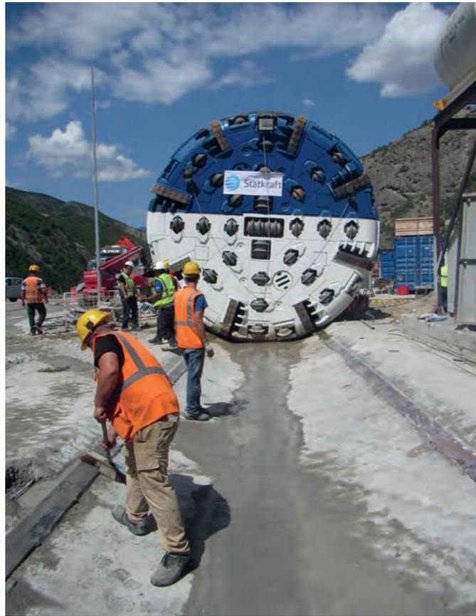
1 Die Crossover XRE TBM mit 6,2 m Durchmesser ist die erste Maschine dieser Art, die in Europa eingesetzt wird
