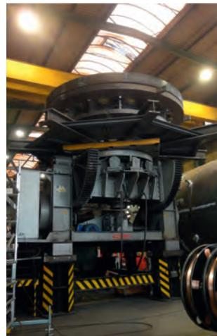
Monoblockgetriebegehäuse: Für die bis maximal 25 t schwerste Einheit der TBM liefert Dillinger bis zu 240 mm dicke Grobbleche
