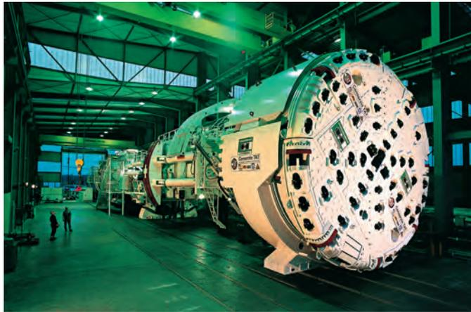
450 m lang, 3000 t schwer, 9,43 m Bohrdurchmesser: Als bisher längste Herrenknecht-TBM mit Dillinger-Grobblechen war „Sissi“ an den Ausbruchsarbeiten des Gotthard Basistunnels beteiligt
