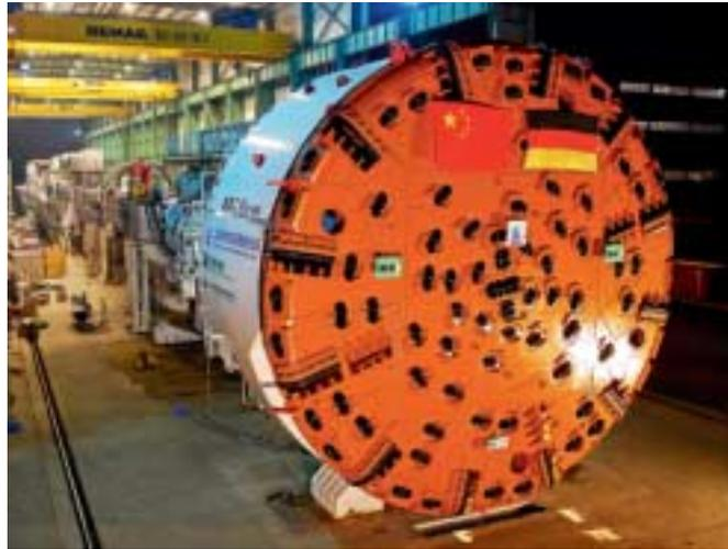
1 Die größte Gripper-TBM der Herrenknecht AG: S-405 mit einem Durchmesser von 12,40 m
