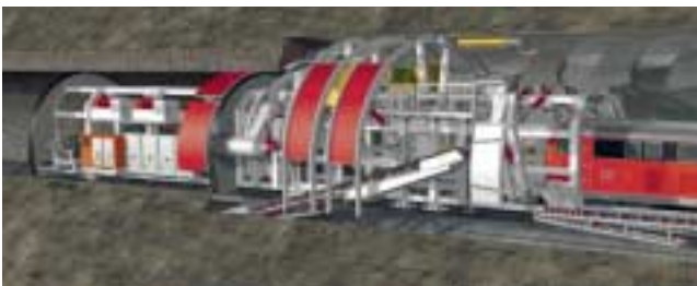
Foto 2 Prinzipieller Aufbau einer Profilaufweitungsmaschine für den Einsatz unter Bahnbetrieb
