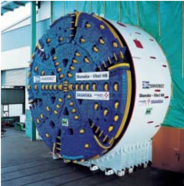
3 TBM S-246 Hallandsas in der Vormontage im Werk
