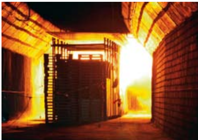
2 Innerhalb weniger Minuten nach Zündung wurden ca. 200 MW erreicht
