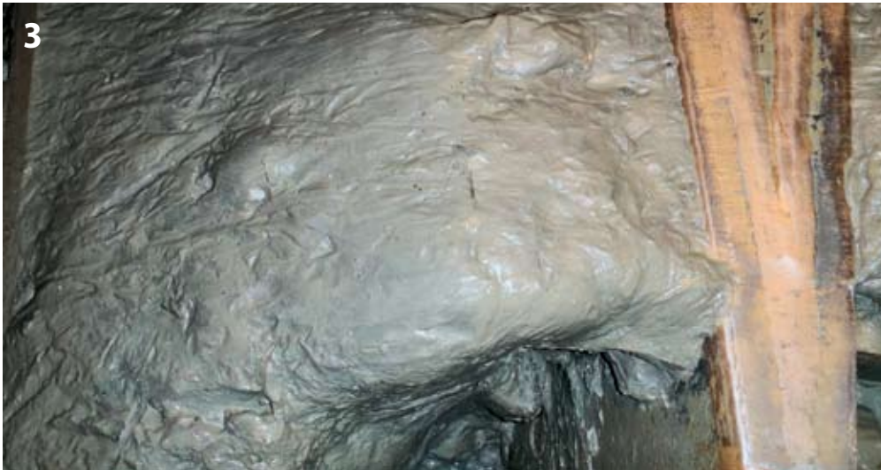
Verklebung des Schneidrades durch den Boomse Klei Cutting wheel arm with clogging Boom Clay
