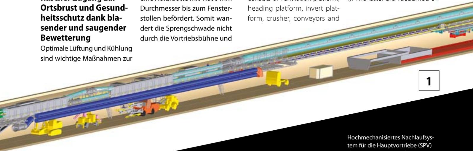
Hochmechanisiertes Nachlaufsystem für die Hauptvortriebe (SPV) des Ceneri-Basistunnels
