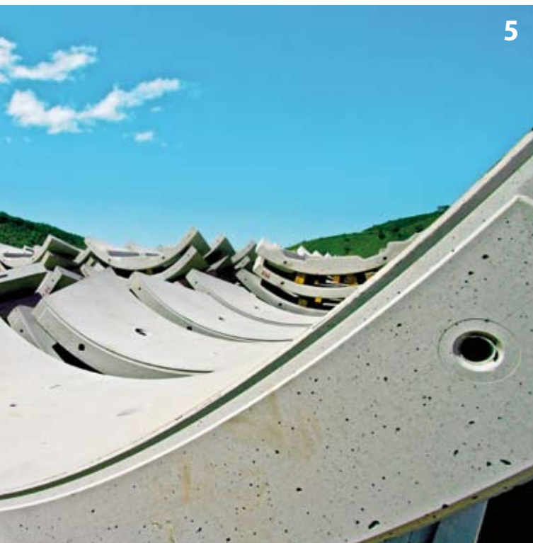
Schwungvoll: Die ersten Tübbinge auf der Insel haben eine besondere Form, sie sind trapezoid
