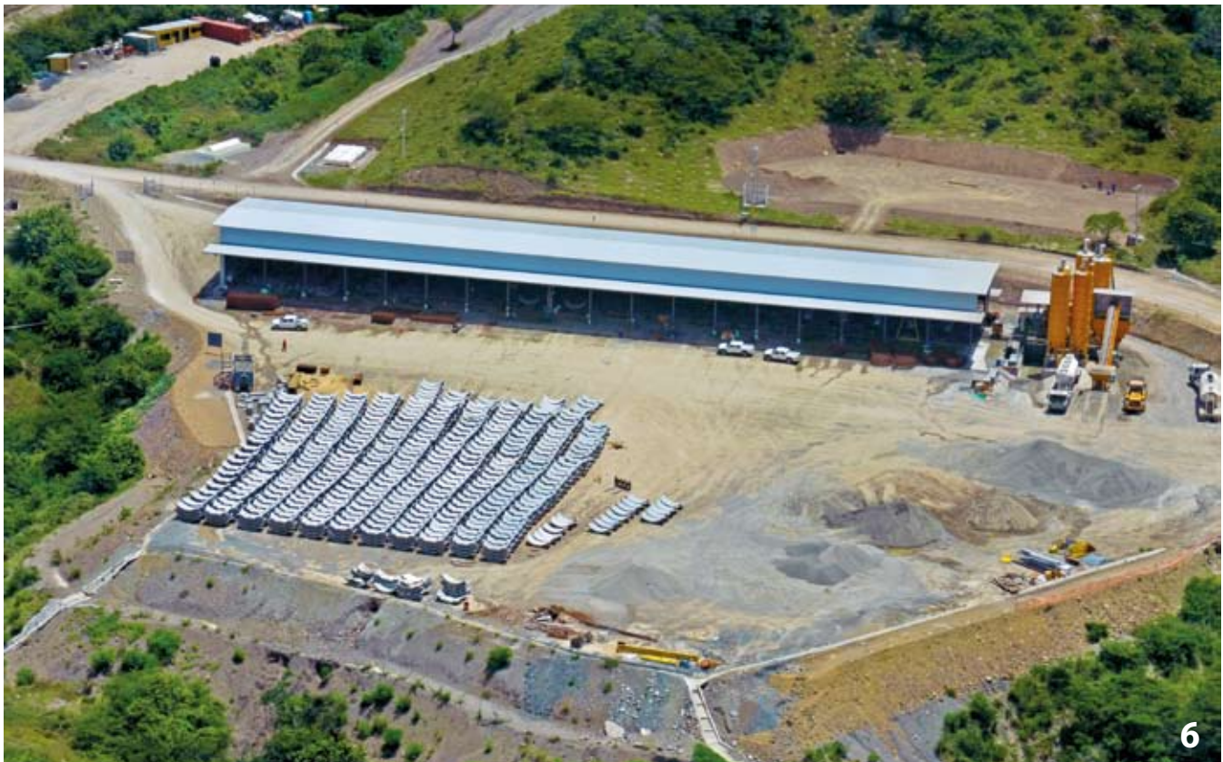
Sonnenbad: Tausende Tübbinge stapeln sich zum Erhärten vor der Fabrik
