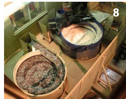
Automatische Förderung und Dosierung mit Incite DE SF 500, Dramix Stahldrahtfasern und Duomix M6
