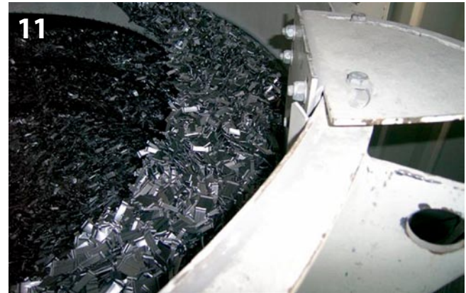
11 Geklebte Stahldrahtfasern für hohe Dosiergenauigkeit und -geschwindigkeiten Glued steel wire fibres for exact dosage and high dosing speeds
