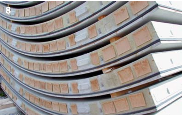
8 Lastverteilungsplatten Load distribution plates
