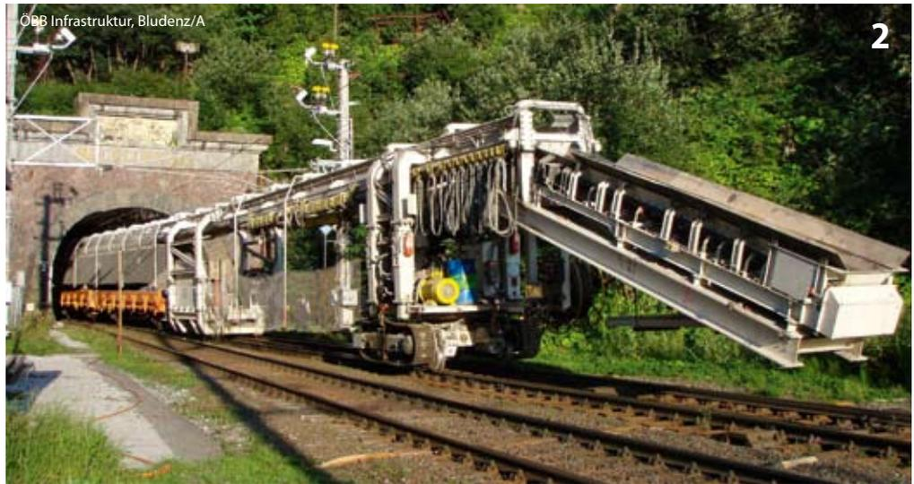
Gleiskörperabtragseinrichtung zur Erneuerung des Arlbergtunnels
