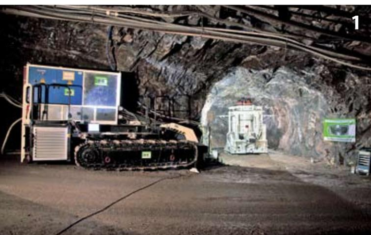
Neu entwickelte Boxhole Boring Machine (BBM)
