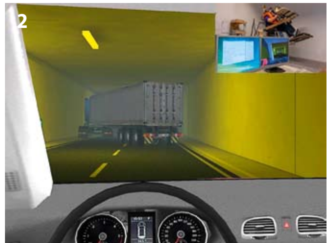
Screenshot des virtuellen Fahrtrainings. Im rechten oberen Bildrand ist ein Proband in einem Fahrsimulator abgebildet. Ein sogenanntes Head Mounted Display versetzt ihn in die virtuelle Welt und er kann mit Steuerelementen in der virtuellen Welt navigieren
