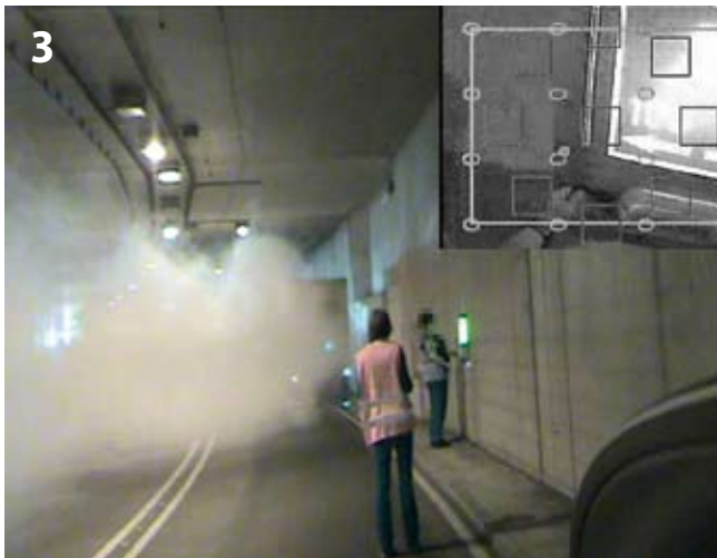
Beispiel einer Probandin (rechts im Bild), die versucht über die Fluchtwegbeschilderung einen Notruf abzusetzen. Eine Versuchsleiterin mit Warnweste beobachtet die Teilnehmerin. Im Hintergrund befindet sich der simulierte Unfall. Der Bildausschnitt rechts oben zeigt die Situation aus Sicht der Probandin
