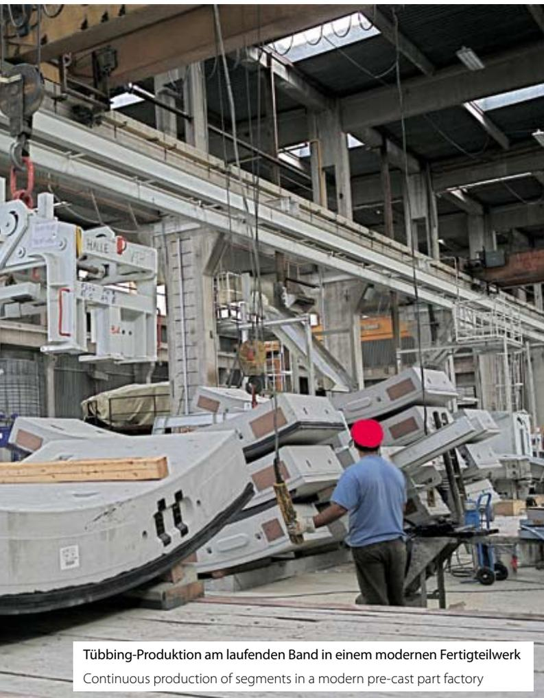
Tübbing-Produktion am laufenden Band in einem modernen Fertigteilwerk
