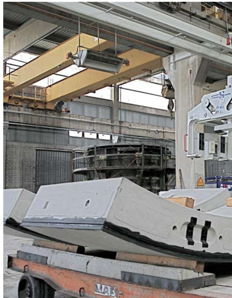
wurden 12.144 Einzelemente produziert, die für beide Bauabschnitte insgesamt 1.518 Ringe ergaben. Die Betonringe wurden konisch hergestellt.
