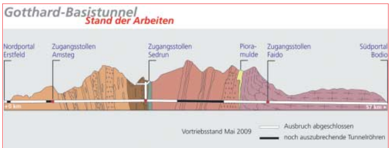
2 Stand der Arbeiten am Gotthard-Basistunnel
