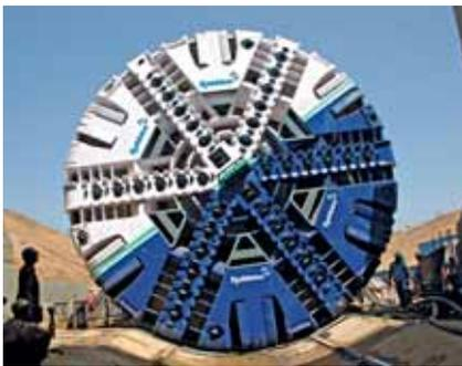
Hybrid-EPB, wie zum Beispiel diese von Robbins mit 10 m Durchmesser für Sleemanabad Carrier Canal in Indien, finden größeren Zuspruch, Seite 20 ff.
