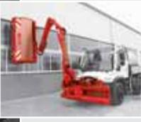
Diese Front-Ausleger werden mit entsprechenden Vorsätzen zu Reinigungs-Profis für Wände, Verkehrsschilder und Leitpfosten...
