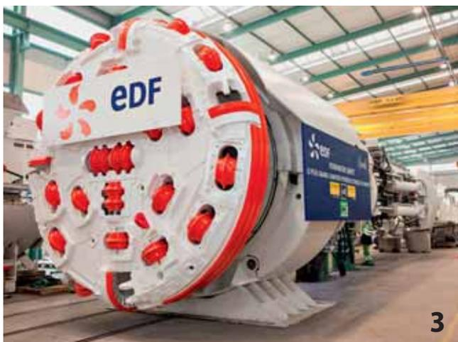
Gripper-TBM für die Chute-de-Gavet-Tunnel (Werksabnahme der ersten Gripper-TBM im November 2012)
